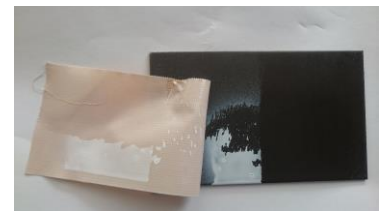
クロム酸処理アルミ板防食性塩水吹付試験 240 時間
